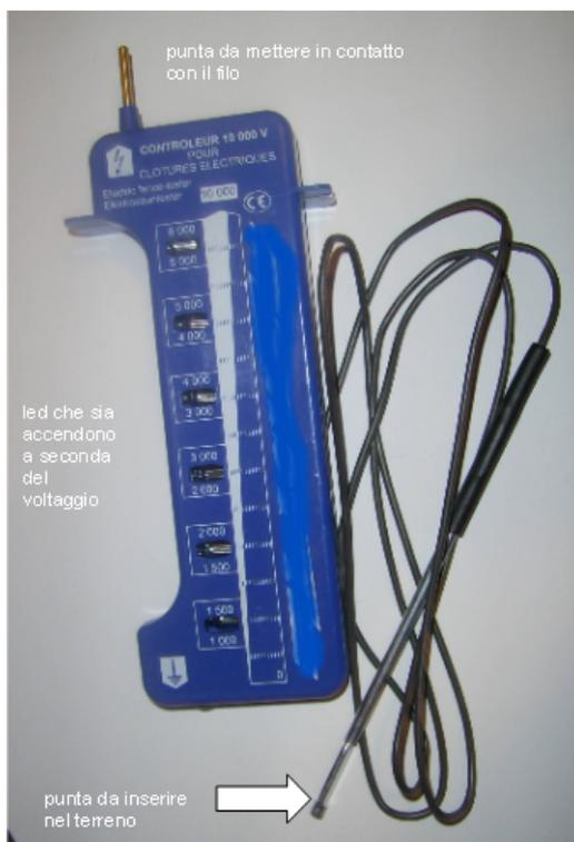
Con uno strumento di facile uso l'agricoltore dovrà **controllare periodicamente che l'impianto sia in buone condizioni di efficienza**. Lo strumento in questione è il voltmetro a *led*, che segnala la differenza di potenziale.
