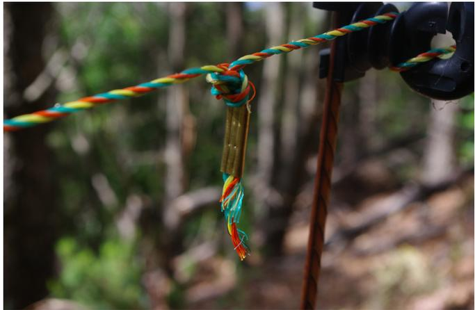
corrente e un danneggiamento del filo conduttore. Può essere sufficiente utilizzare le apposite guaine metalliche che utilizzano gli elettricisti.
